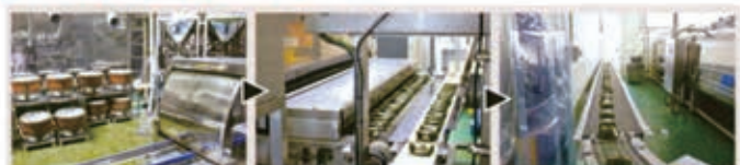
▲炊飯器でおいしく炊き上げ（少量多品種用） ▲型で三角になり、具が入って海苔が巻かれる。 ▲どんどんおにぎりが流れてきて、トンネルフリーザー約40分で凍結
