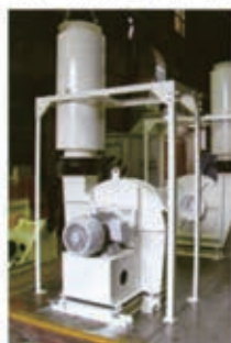
▲ サイレンサー付送風機
