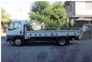
パワーゲート車の車高は2.2mが多いが、同社は2.07mと少し低めで高さ制限をクリア
