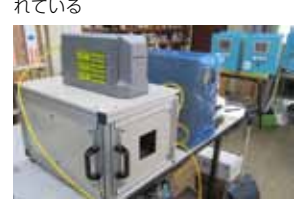
インドネシアに送られる自動滑材充填システムの一部 金属に文字を書けるレーザーマーカ
