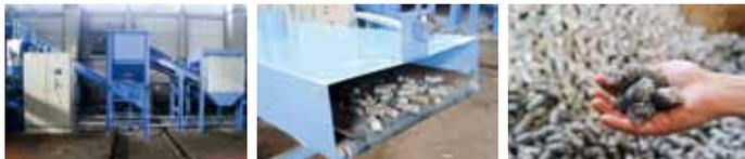
中間処理ラインで選別された紙・木・プラスチック・繊維はRPF（固形燃料）製造ラインへ流される。選別した資源を細かく粉砕・加圧・圧縮によりRPF（固形燃料）を形成。完成後は製紙会社や製鉄会社に販売している。
