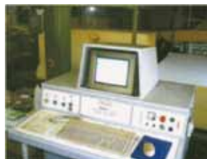
異型カッター CADシステムとの併用により、入力された図形が思いのままにカットできる「異型カッター（二次元加工機）」
