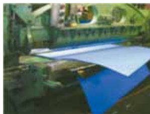
漉き加工 お客様の要望に合わせて自由自在に厚みをスライスできる「漉き加工」
