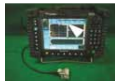
「フェイズドアレイ超音波探傷検査」は鋼材の内部亀裂など損傷の定量評価を行う。超音波16方向入射で法範囲をカバーする
