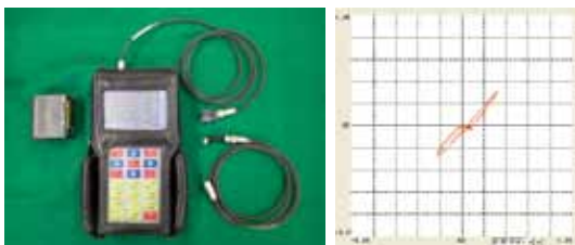
「携帯式渦流探傷装置 HIMEX-V2」は 亀裂がある場合は上記のような波形になる。塗膜や錆の除去など下処理が不要な渦流方式。安定した検査が可能
