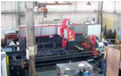
世界にひとつの長尺角丸パイプ切断可能なレーザー機。8 m もの長さのカットが可能
